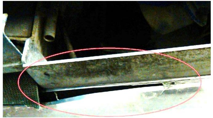
verschlossene, scharfkantige seitliche Bandunterstützung, verantwortlich für die Zerstörung und den Ausfall des Transportbandes
